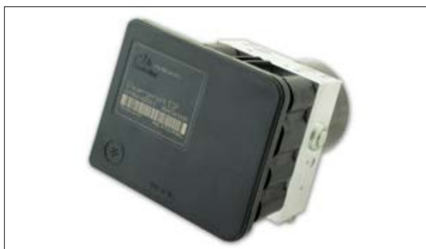
ATE MK60 - Fehler: „Bremsdrucksensor defekt“
