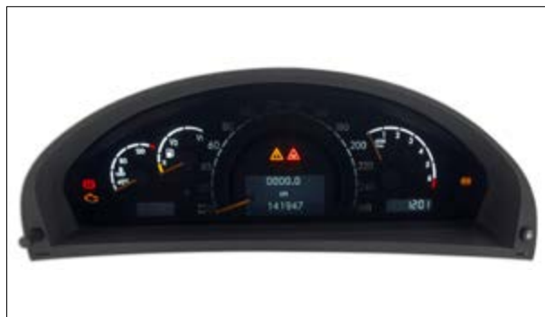
Ausfall der Hintergrund-Beleuchtung
