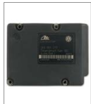
Diverse Fehler (z.B. keine Kommunikation oder Fehler „Radsensor defekt“)
