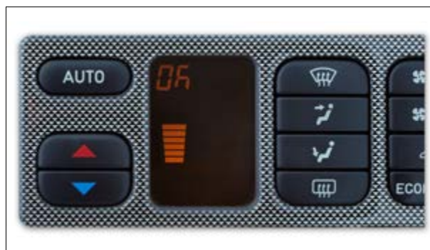
Pixel- oder Segmentfehler
