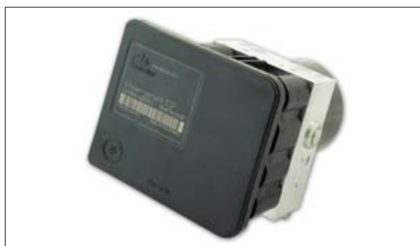
ATE MK60 - Fehler: „Bremsdrucksensor defekt“
