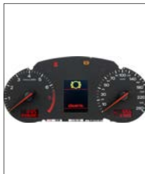
Pixel- oder Segmentfehler
