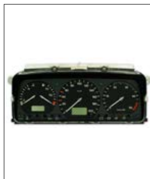
Fehlerhafte Temperatur- und/oder Tankanzeige
