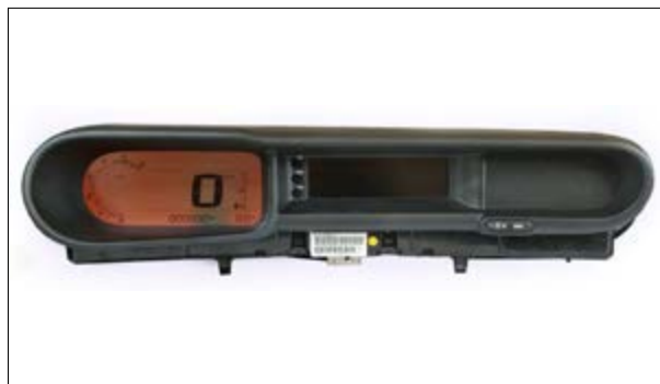
Ausfall der Hintergrund-Beleuchtung
