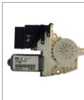
Sporadischer Ausfall der elektrischen Fensterheber
