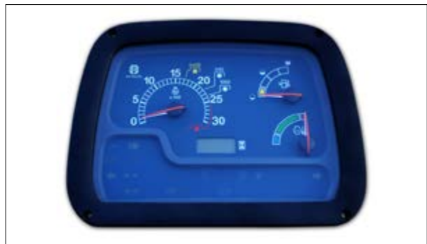
Drehzahlmesser ohne Funktion und Betriebsstunden werden nicht gezählt
