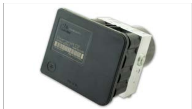
ATE MK60 - Fehler: „Bremsdrucksensor defekt“
