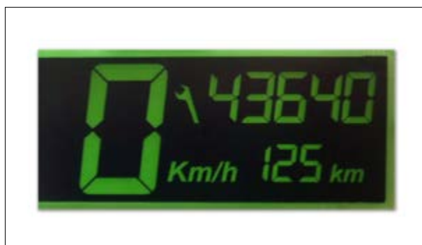
Pixel- oder Segmentfehler
