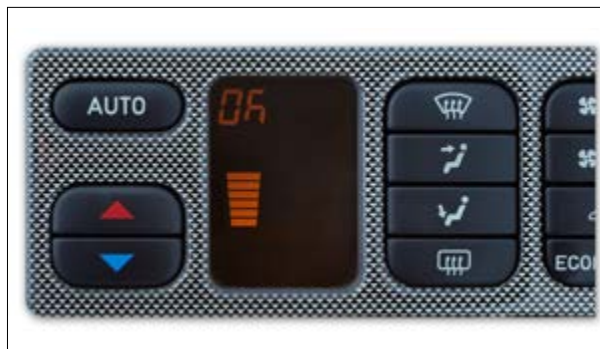
Pixel- oder Segmentfehler
