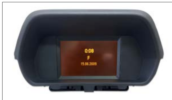
Pixel- oder Segmentfehler bzw. Verblässen der Anzeige
