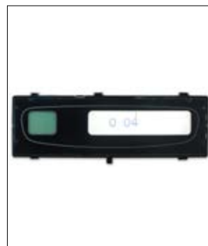
Pixel- oder Segmentfehler
