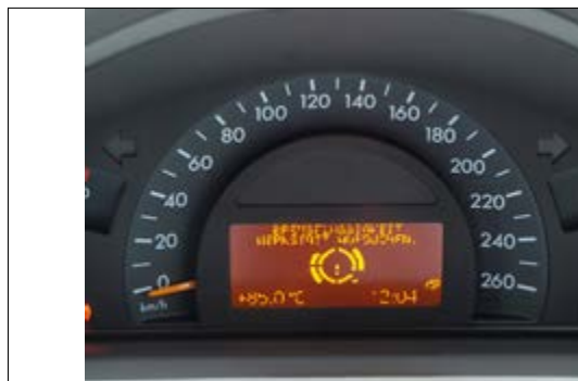
Pixel- oder Segmentfehler
