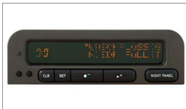
Pixel- oder Segmentfehler
