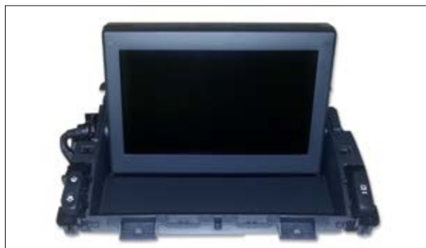
Display hakt beim Ein- oder Ausfahren
