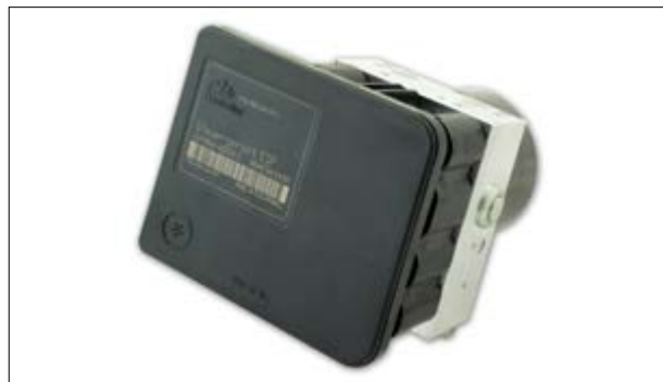
ATE MK60 - Fehler: „Bremsdrucksensor defekt“
