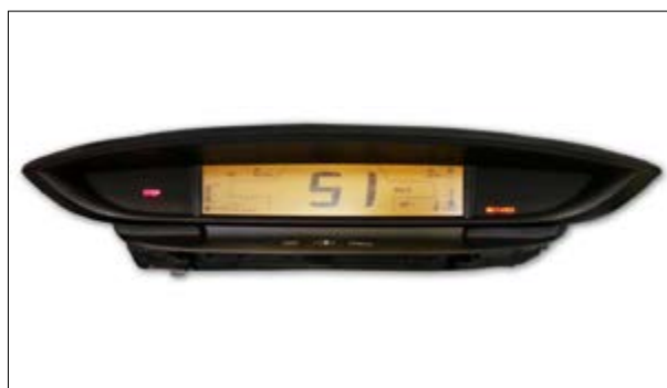
Pixel- oder Segmentfehler bzw. Verblässen der Anzeige
