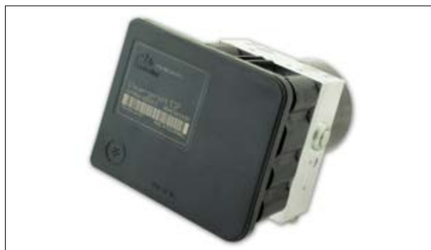
ATE MK60 - Fehler: „Bremsdrucksensor defekt“
