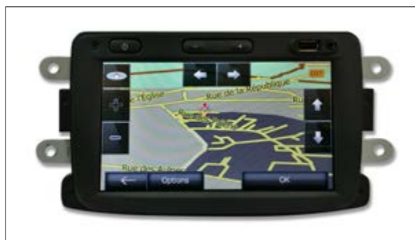
Sporadischer Totalausfall oder Boot-Loop
