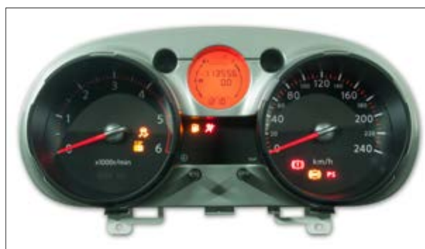
Drehzahlmesser und/oder Hintergrund-Beleuchtung ohne Funktion
