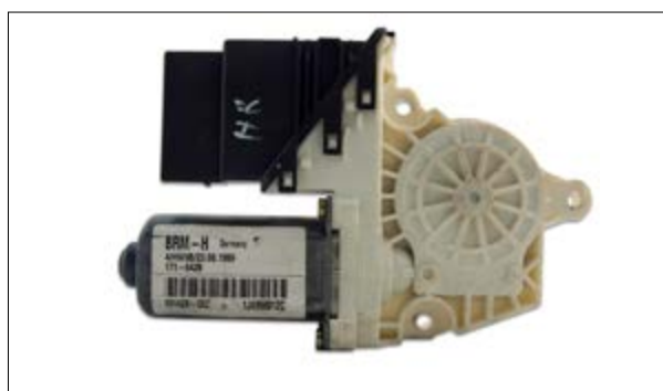
Sporadischer Ausfall der elektrischen Fensterheber
