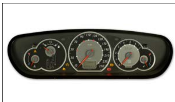
Fehlerhafte Analoganzeigen KMH/DZM
