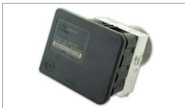
ATE MK60 - Fehler: „Bremsdrucksensor defekt“
