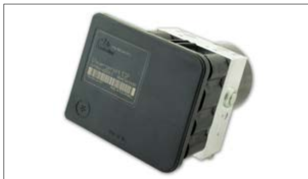
ATE MK60 - Fehler: „Bremsdrucksensor defekt“
