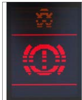
Pixel- oder Segmentfehler
