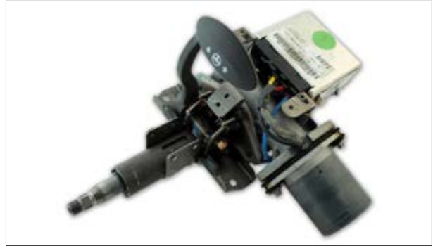
Sporadischer oder permanenter Ausfall der elektrischen Servolenkung
