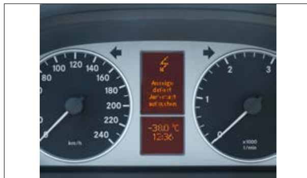
Pixel- oder Segmentfehler
