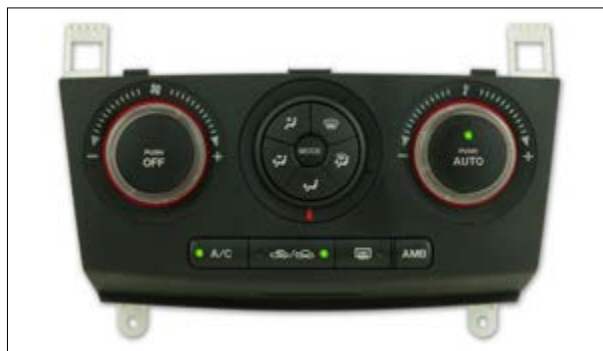
Ausfall der Bedienregler - Temperatur-Einstellung etc. nicht mehr möglich
