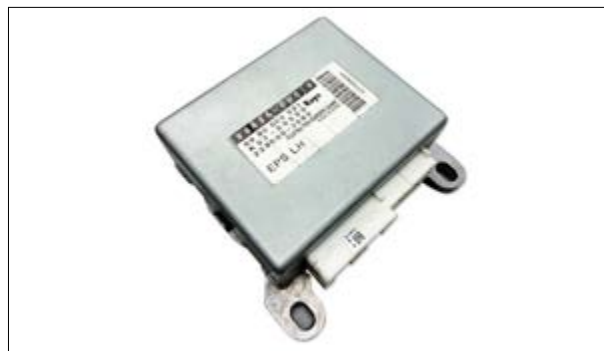
Sporadischer oder permanenter Ausfall der elektrischen Lenkunterstützung
