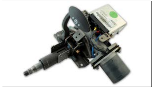
Sporadischer oder permanenter Ausfall der elektrischen Servolenkung
