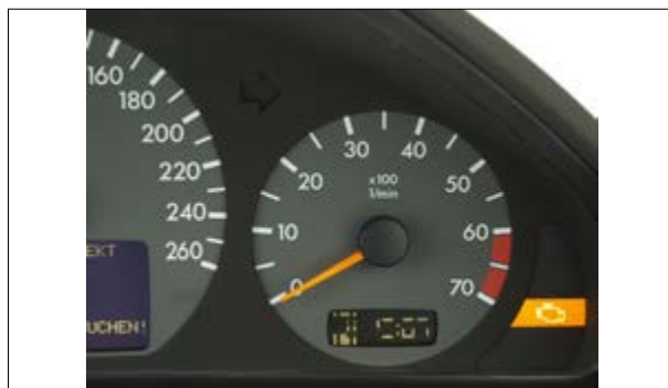
Pixel- oder Segmentfehler
