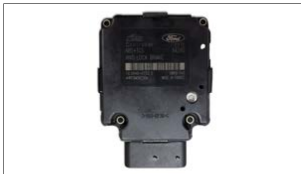
Diverse Fehler (z.B. „Pumpenmotor defekt“ oder Fehler „Ventil-Relais“)
