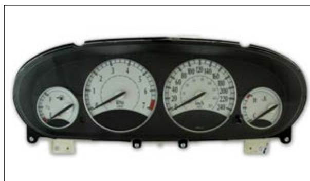
Ausfall der Hintergrund-Beleuchtung
