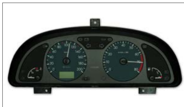
Fehlerhafte Analoganzeigen KMH/DZM
