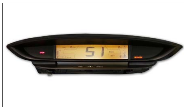
Pixel- oder Segmentfehler bzw. Verblässen der Anzeige
