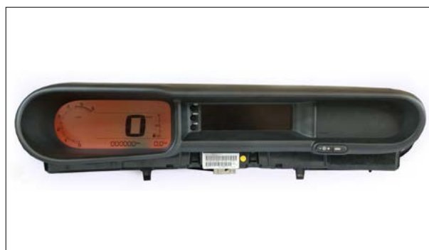
Ausfall der Hintergrund-Beleuchtung
