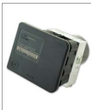
Fehler: „Bremsdrucksensor defekt“
