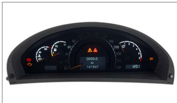
Ausfall der Hintergrund-Beleuchtung
