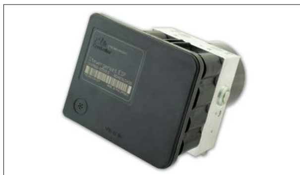
ATE MK60 - Fehler: „Bremsdrucksensor defekt“
