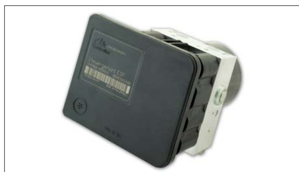
ATE MK60 - Fehler: „Bremsdrucksensor defekt“
