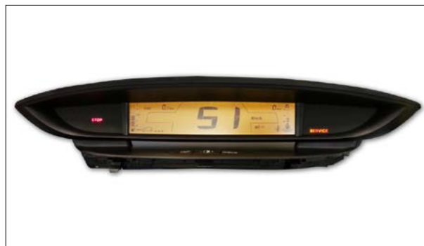
Pixel- oder Segmentfehler bzw. Verblässen der Anzeige
