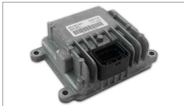
Fahrzeug geht sporadisch in den Notlauf oder der Motor ruckelt sehr stark - Fehlercode: P0251
