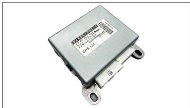
Sporadischer oder permanenter Ausfall der elektrischen Lenkunterstützung
