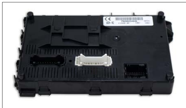
Beispiel-Bild (BSI | UCH | Zentralelektrik)
