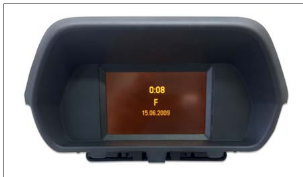
Pixel- oder Segmentfehler bzw. Verblässen der Anzeige
