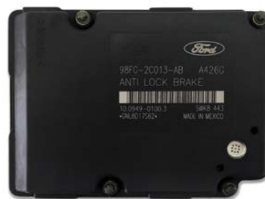
ATE MK20 - Diverse Fehler (z.B. Fehler: „Pumpenmotor defekt“)
