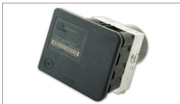
ATE MK60 - Fehler: „Bremsdrucksensor defekt“
