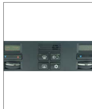
Klima-Bedienteil (IHKA) mit Pixelfehler
