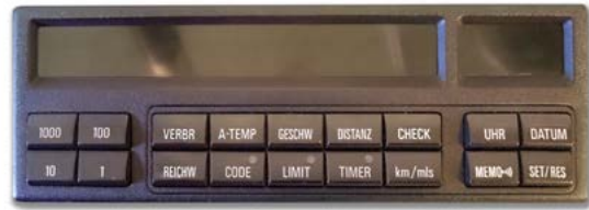
Pixel- oder Segmentfehler bzw. Verblässen der Anzeige
