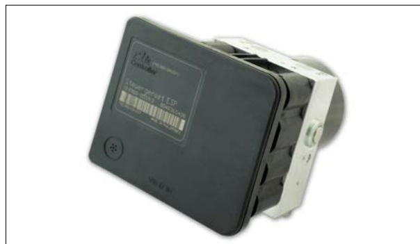
ATE MK60 - Fehler: „Bremsdrucksensor defekt“
