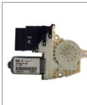
Sporadischer Ausfall der elektrischen Fensterheber
