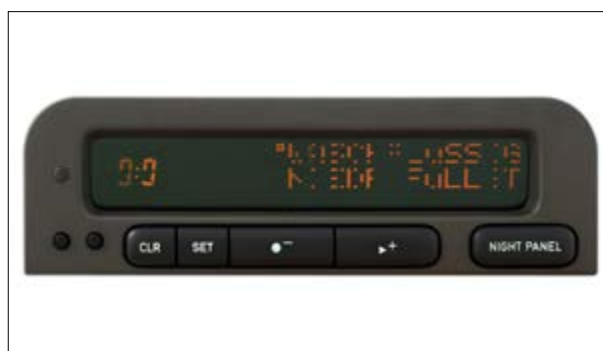
Pixel- oder Segmentfehler
