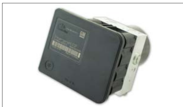
ATE MK60 - Fehler: „Bremsdrucksensor defekt“
