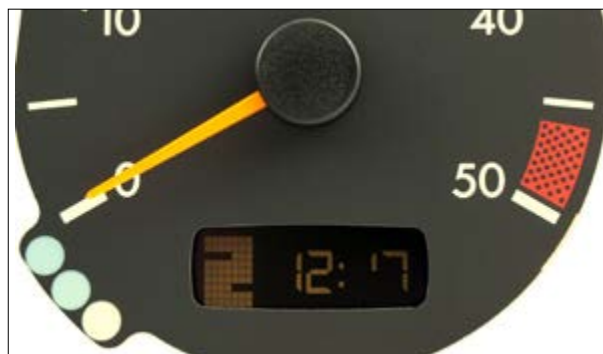
Pixel- oder Segmentfehler
