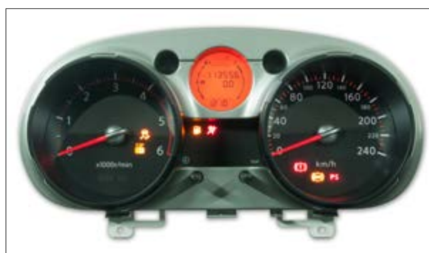
Drehzahlmesser und/oder Hintergrund-Beleuchtung ohne Funktion
