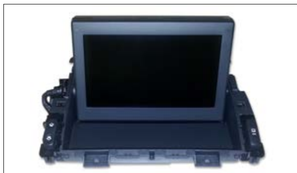
Display hakt beim Ein- oder Ausfahren
