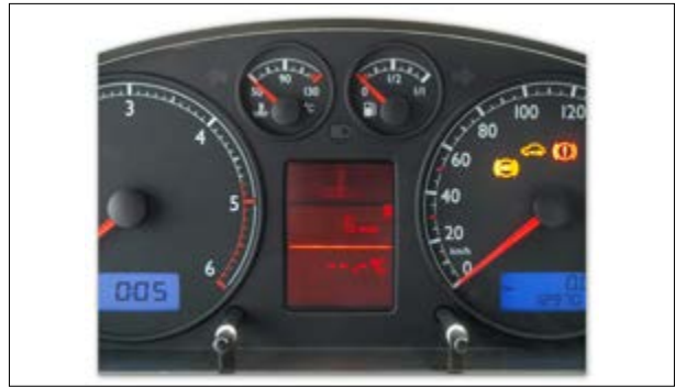
Pixel- oder Segmentfehler
