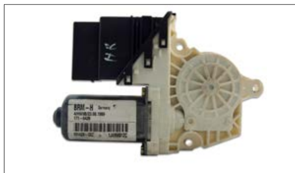
Sporadischer Ausfall der elektrischen Fensterheber
