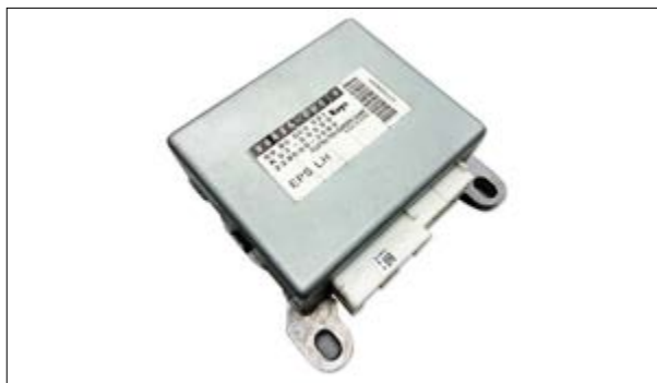
Sporadischer oder permanenter Ausfall der elektrischen Lenkunterstützung
