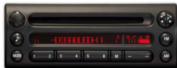
Pixel- oder Segmentfehler
