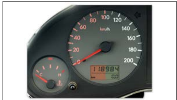
Ausfall der Hintergrund-Beleuchtung
