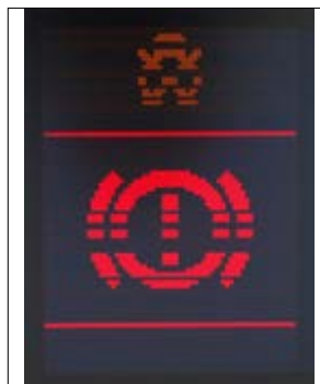
Pixel- oder Segmentfehler
