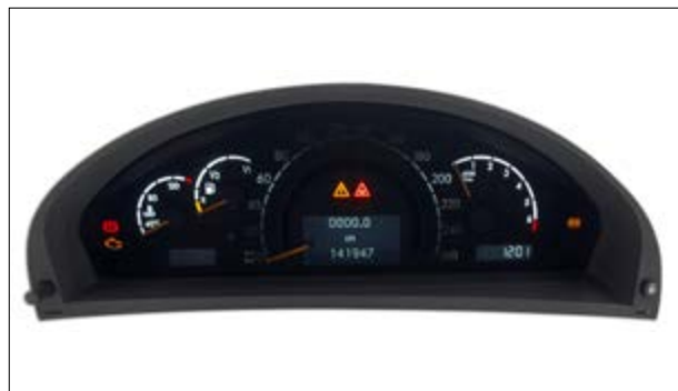
Ausfall der Hintergrund-Beleuchtung
