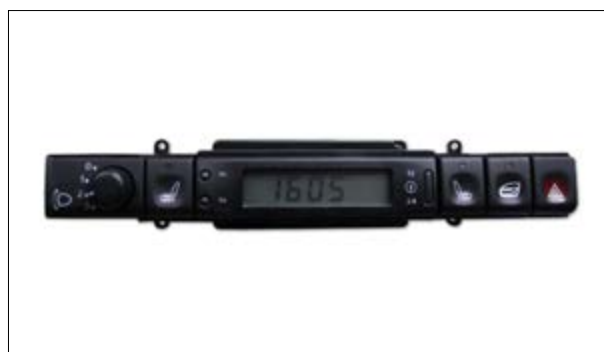
Pixel- oder Segmentfehler bzw. Verblässen der Anzeige
