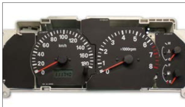
Fehlerhafte Geschwindigkeitsanzeige und Display ohne Funktion
