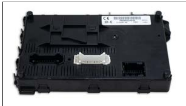
Beispiel-Bild (BSI | UCH | Zentralelektrik)
