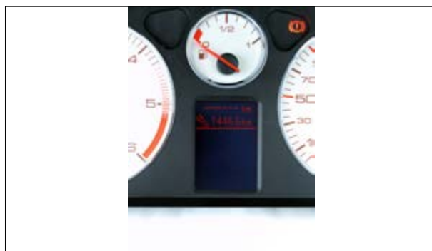
Pixel- oder Segmentfehler
