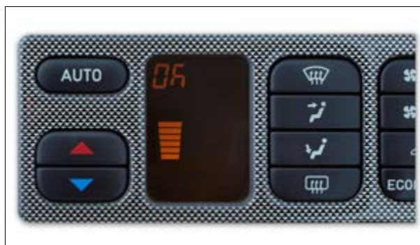
Pixel- oder Segmentfehler
