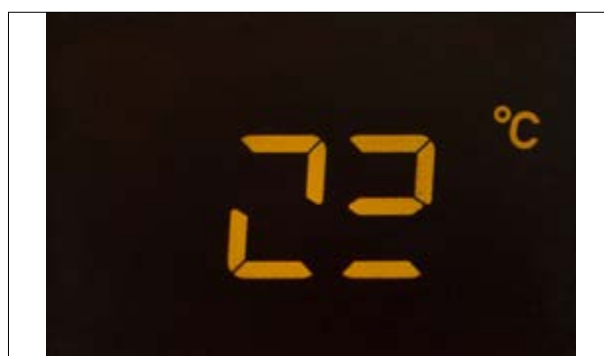
Pixel- oder Segmentfehler
