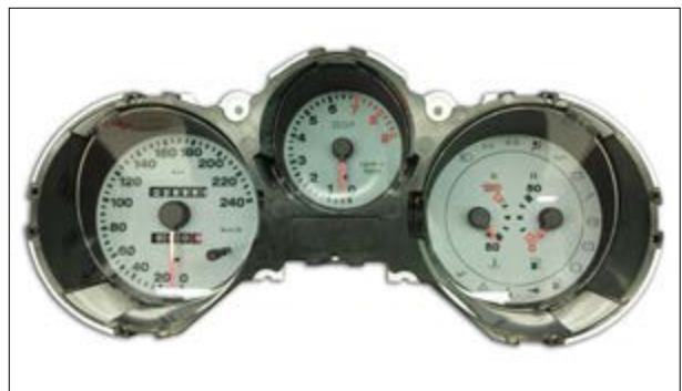
Gesamtwegstrecke und Tageskilometer werden nicht weitergezählt; TRIP-Knopf ohne Funktion
