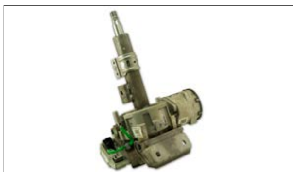
Sporadischer oder permanenter Ausfall der elektrischen Servolenkung
