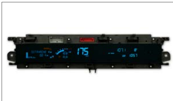
Sporadischer Totalausfall oder Fehlfunktionen, Wegstrecke springt hoch
