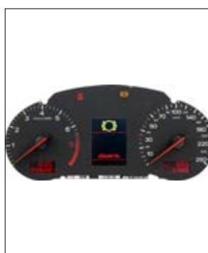
Pixel- oder Segmentfehler
