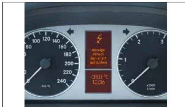
Pixel- oder Segmentfehler
