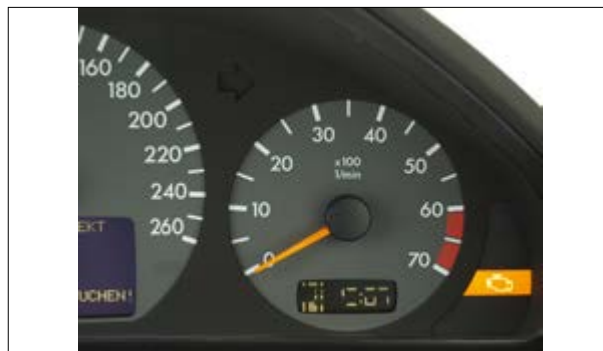
Pixel- oder Segmentfehler
