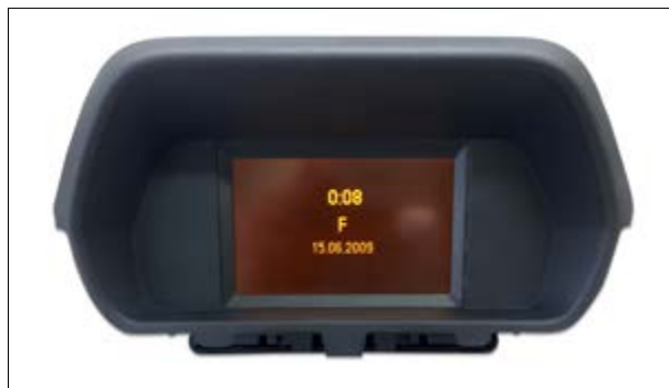
Pixel- oder Segmentfehler bzw. Verblassen der Anzeige
